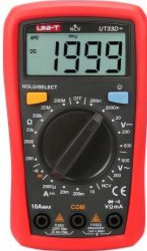
סדרת UT33+ מהדור החדש מגדירה מחדש את תקני הביצועים עבור מולטי מטרים דיגיטליים ברמת הכניסה. העיצוב התעשייתי החדשני שלנו מבטיח שמוצרים אלו יכולים לעמוד בצניחה של 2 מטרים. פריסת תצוגת ה-LCD החדשה מספקת חווית משתמש טובה יותר. סדרה זו מבטיחה שמשתמשים יכולים לעבוד בבטחה בסביבת CAT II 600V.
